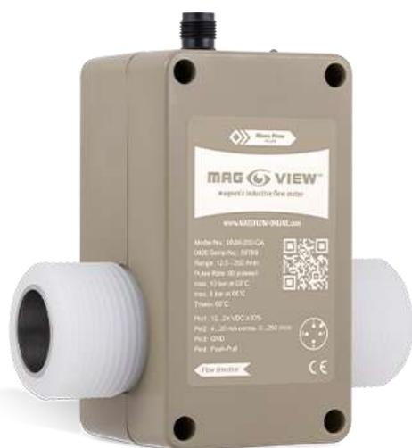
Расходомер MAG-VIEW MVM-250-QA - это экономичный прибор с измерительной трубкой из ПВДФ DN25 для расходов 12,5... 250 л / мин, пригодный для рабочих давлений до 10 бар (изб.). Аналоговые и импульсные выходные сигналы прибора пропорциональны расходу.
